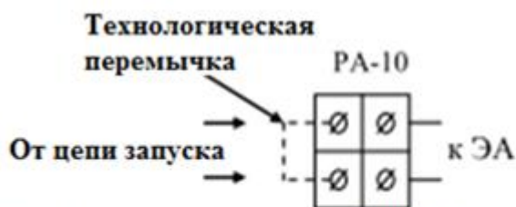
Рис.2 - Схема подключения ТРВ-Гарант вар. 1 с ППК общего пользования
