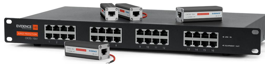
**CROSS 1/kV** устанавливается непосредственно перед защищаемым устройством и при скачке направляет избыток энергии в контур заземления. Таким образом предотвращается повреждение дорогостоящей IP-камеры или коммутатора.
