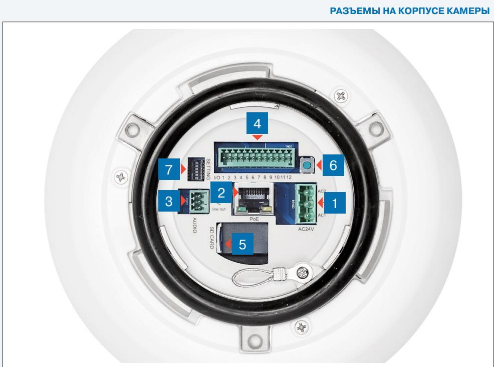
**1** Разъемы для подключения электропитания
