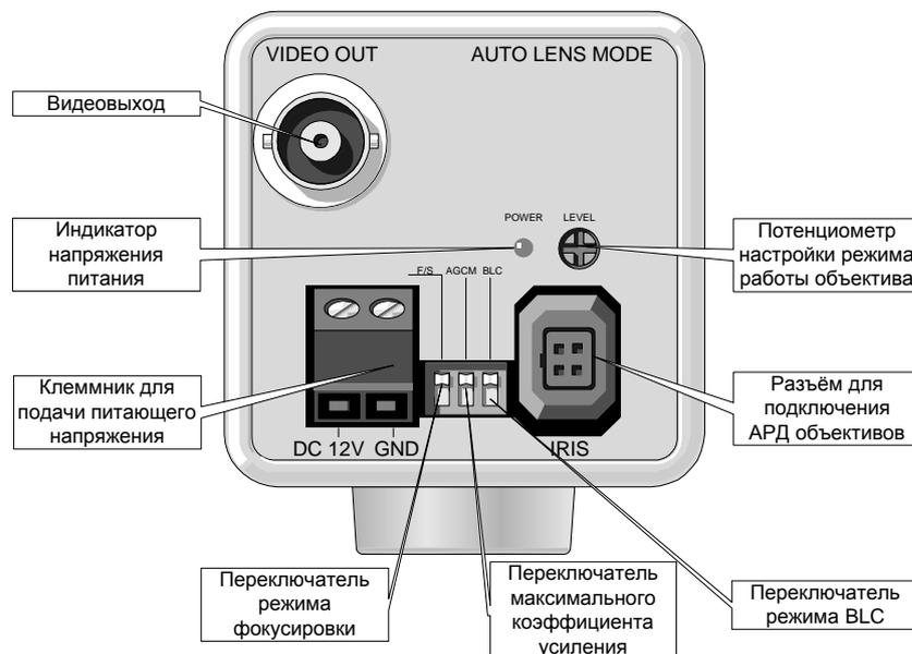
Рис.1. Камера **VMC-740-HR**. Органы регулировки и разъёмы для подключения питания, объектива и монитора.
