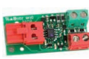
**Интерфейс BUS XIB** (в случае применения платы E024S с фотоэлементом, не поддерживающим шинное соединение)
