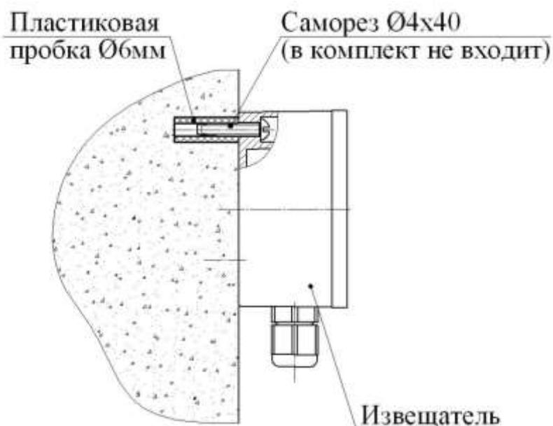
Рисунок 1 – Крепление извещателя.
