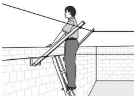
Рисунок 2.10. Имитация преодоления зоны обнаружения при козырьковом варианте установки.
