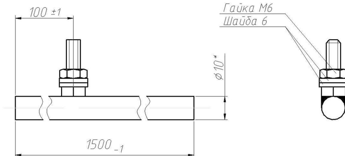
Заземлитель изготовлен из стального прутка, не окрашен.
