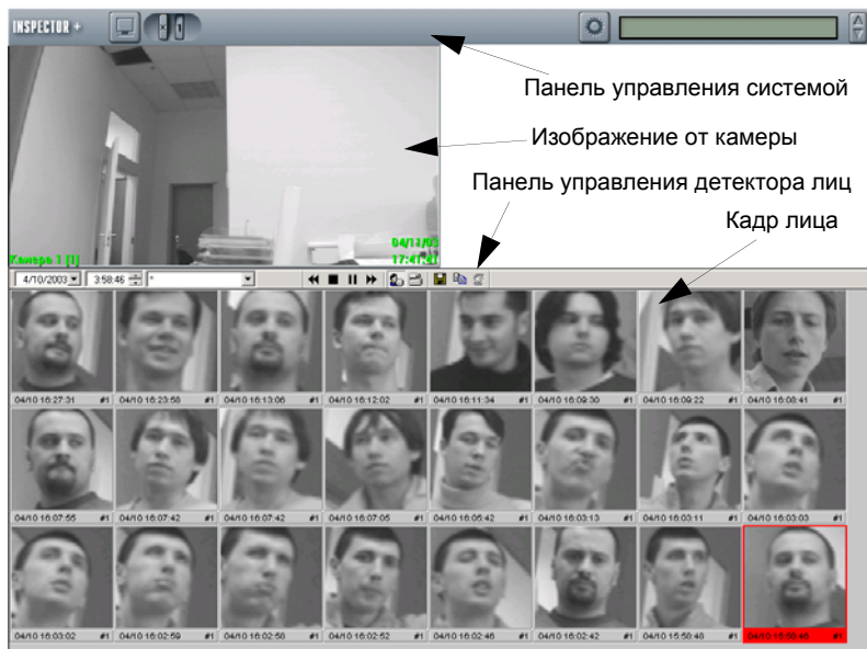
Рис. 10 Вид рабочего места оператора FaceInspector
