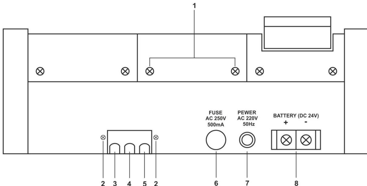
Рисунок 2. Внешний вид задней стороны корпуса пультов громкой связи
