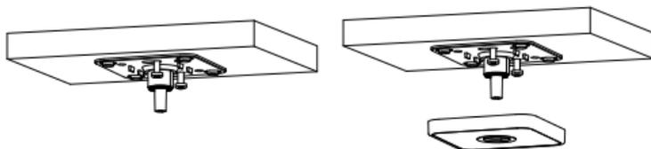
Рисунок 3-4 Установка крепежной основы и монтажной платформы
