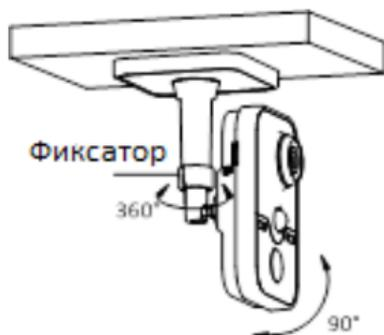
Рисунок 3-6 Регулировка камеры
