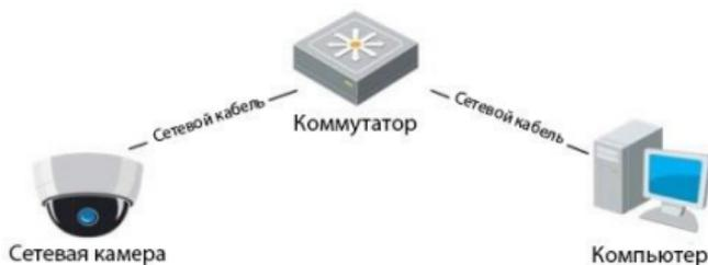
Рисунок 3-1 Подключение по LAN
