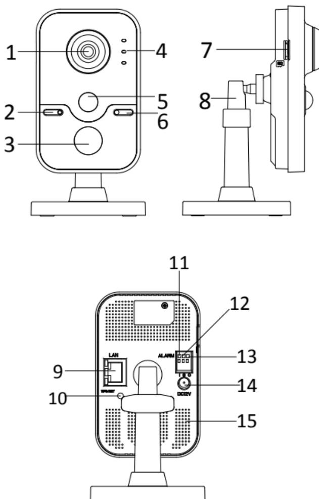
Рисунок 1-1 Внешний вид видеокамеры
