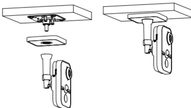
Рисунок 3-5 Установка камеры
