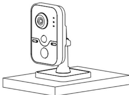
Рисунок 3-2 Установка камеры на кронштейн
