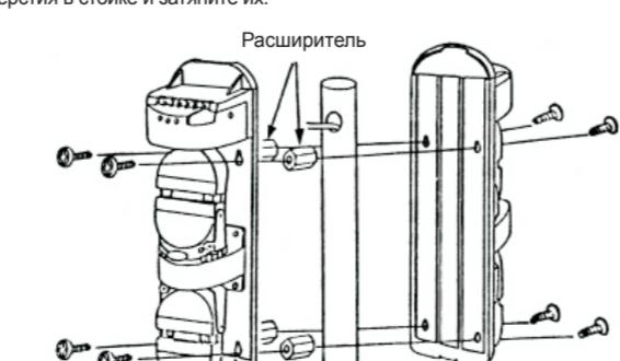
1. Для каждого устройства используются 4 расширители (дополнительные элементы).
