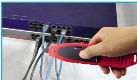
а) Трассировка кабеля витая пара (RJ45/RJ11)
