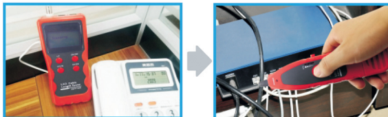
а) Трассировка кабеля витая пара (RJ45/RJ11)
