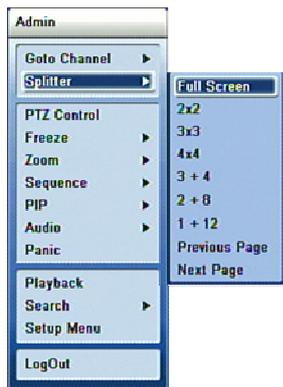
Рис. 48 – Мультиэкраны в режиме реального времени
