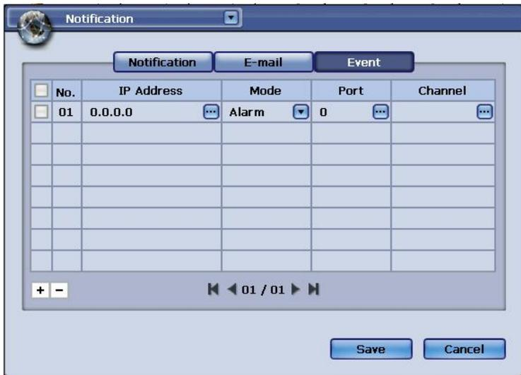
**Рис. 105 - Окно настройки параметров оповещения (вкладка Event)**
