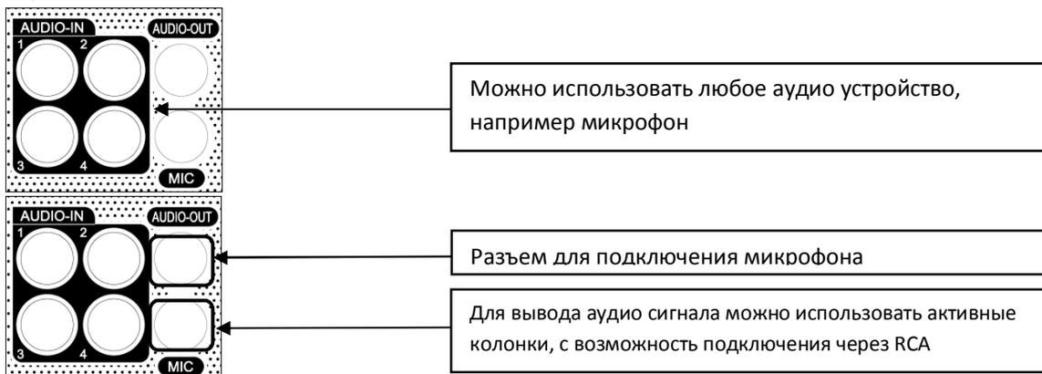
Рис. 9 – Аудио Входы / Выход и микрофонный вход
