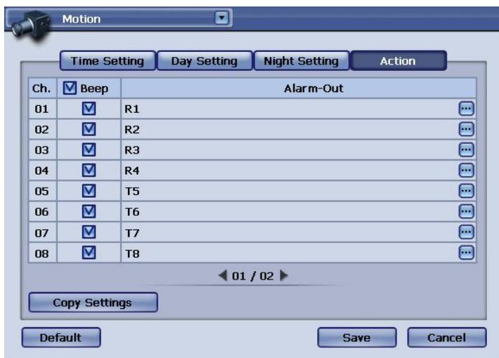
**Рис. 64 – Окно настроек действий при обнаружении движения**
