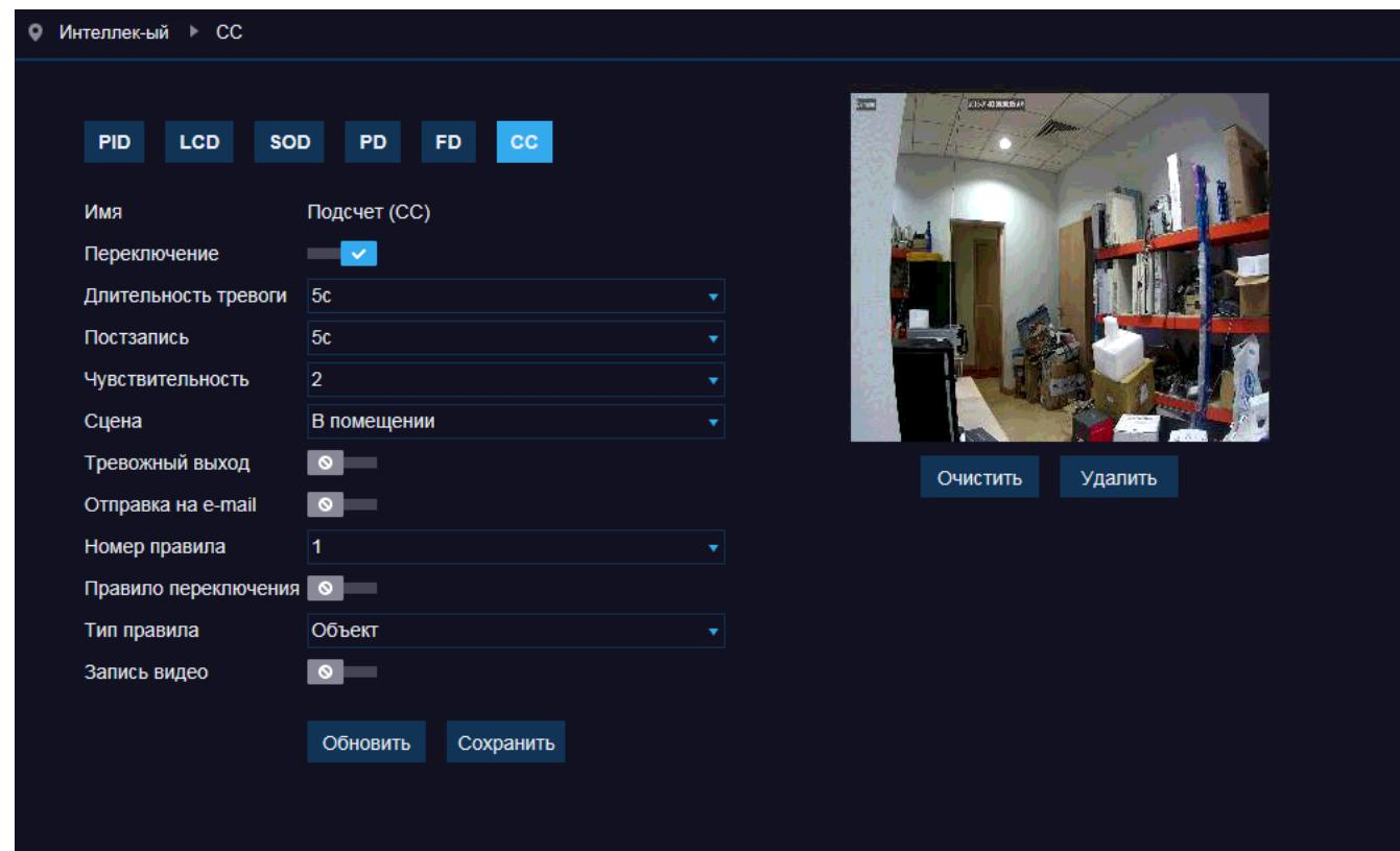
Чтобы указать границу, которую человек должен пересечь, чтобы система определила его как вошедшего или вышедшего, выполните щелчок левой кнопки мыши внутри окна просмотра в том месте, где находится первая точка. Затем укажите вторую точку. Чтобы изменить положение линии, выполните двойной щелчок внутри красного квадрата вблизи первой точки.
