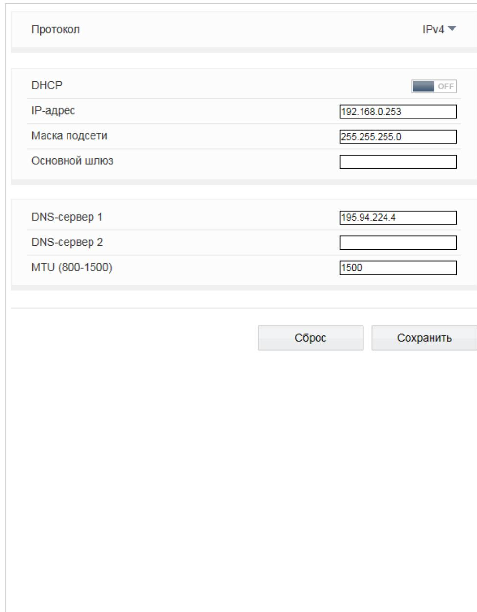
Раздел позволяет задать IP-адрес и сетевые параметры камеры вручную, либо выбрать режим автоматического получения IP-адреса и сетевых параметров от сервера DHCP.
