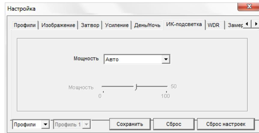
\*\* Вкладка доступна только для моделей на базе процессора Hisilicon 3516C и матрицы IMX322, оснащенных встроенной ИК-подсветкой
