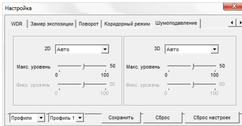
Функция подавления шумов обеспечивает высокое качество изображения в условиях низкой освещенности. Двумерное шумоподавление устраняет шумы, возникающие при съемке статичных сцен, трехмерное – размытость изображения в условиях динамических сцен.
