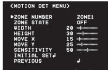
**MOTION DET (ДАТЧИК ДВИЖЕНИЯ):** Камера формирует сигнал при обнаружении движущихся объектов.
