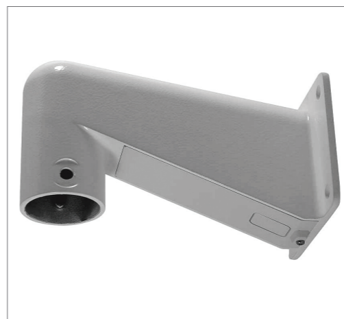
КОМПАКТНЫЙ ПОДВЕСНОЙ КРОНШТЕЙН 184x104x115.2 мм (7.24x4.09x4.54 дюймов); 0.6 кг (1.2 фунтов). Поставляется с резиновой шайбой8x1, Дополнительная шайба трубы-1, Эластичная шайба -8x1 и М8*12 винт-1.
