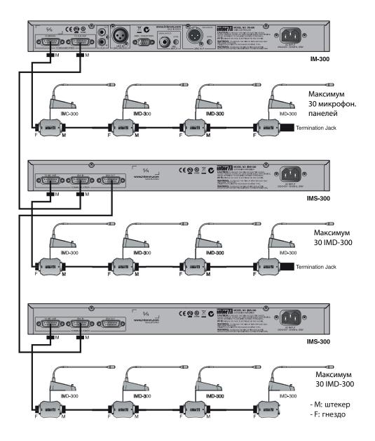
**Примечание**: В случае применения IMS-300 используйте терминаторы для всех крайних микрофонов за исключением последнего.
