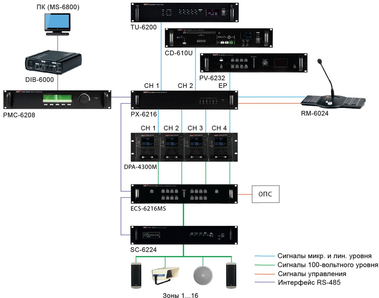
Система построена на основе матричного аудиоконтроллера PX-6216, имеет 4 канала и 16 зон трансляции. Она обеспечивает автоматическую трансляцию тревожных сообщений при пожаре, выполнение сценариев эвакуации, речевое оповещение в выбранных оператором зонах и независимую музыкальную трансляцию от источников сигнала, подключенных к матрице PX-6216. Для усиления сигнала для каждого канала трансляции используется один из каналов усилителя DPA-4300M.
