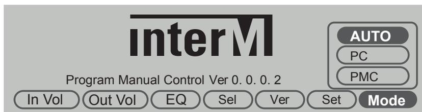
PX-6216 имеет 16 входов для подключения разных источников аудиосигнала: EP, TIMER, RM1-RM4, CH1-CH10. Для регулировки уровней сигналов по каждому входу необходимо выбрать пункт меню InVol. Изменение громкости осуществляется вращением ручки валкодера, расположенной на передней панели PMC-6208.
