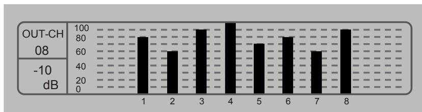
Функция семиполосного графического эквалайзера, поддерживаемая PMC-6208, позволяет оператору выполнить корректировку амплитудно-частотной характеристики каждого аудиовыхода PX-6216. Интервал между полосами составляет 1,3 октавы. Регулировка уровня сигнала в каждой отдельной полосе частот выполняется при помощи валкодера.
