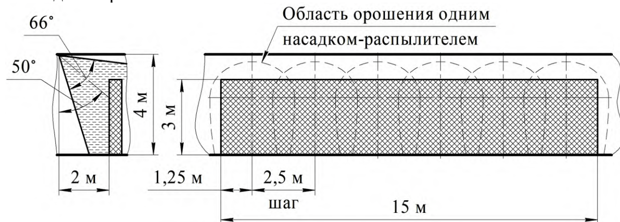
Рисунок 16 – Противопожарная защита боковой поверхности стеллажа 6-ю насадками-распылителями
