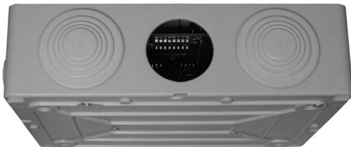
Рисунок 9 – Расположение DIP-переключателей контроллера
