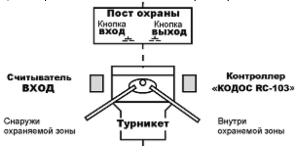
Рисунок 8 – Один внешний считыватель серии «КОДОС RD», контроллер в режиме работы со встроенным считывателем
