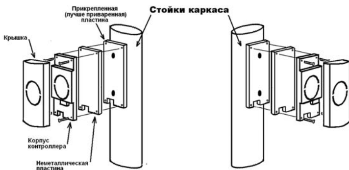
Рисунок 20 – Установка контроллера на общий каркас
