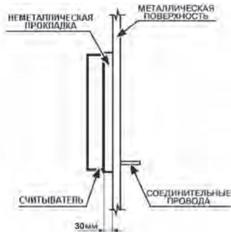
Рисунок 5 – Установка считывателя на металлическую поверхность
