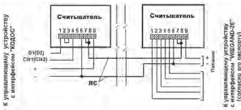
**Рисунок 4 – Пример схемы подключения синхронизированных считывателей к управляющим устройствам с различными интерфейсами**
