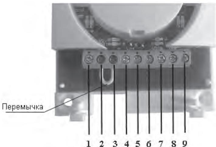
Рисунок 3 – Клеммы считывателя
