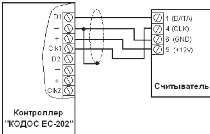
Рисунок 8 – Пример схемы экранирования
