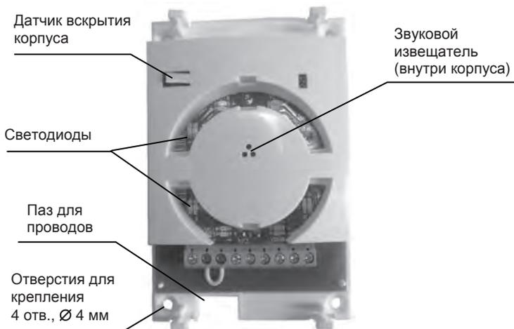
**Рисунок 6 – Вид считывателя без крышки**
