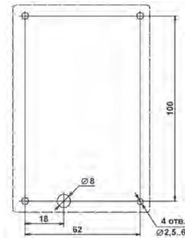
Рисунок 7 – Установочные размеры
