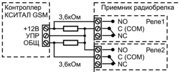
Напряжение на входе "Управление" (если это разрешено в настройке **Управление** на SIM-карте) однозначно определяет режим (0В - на контроле, +12В - контроль снят, +6В - пассивное состояние входа).
