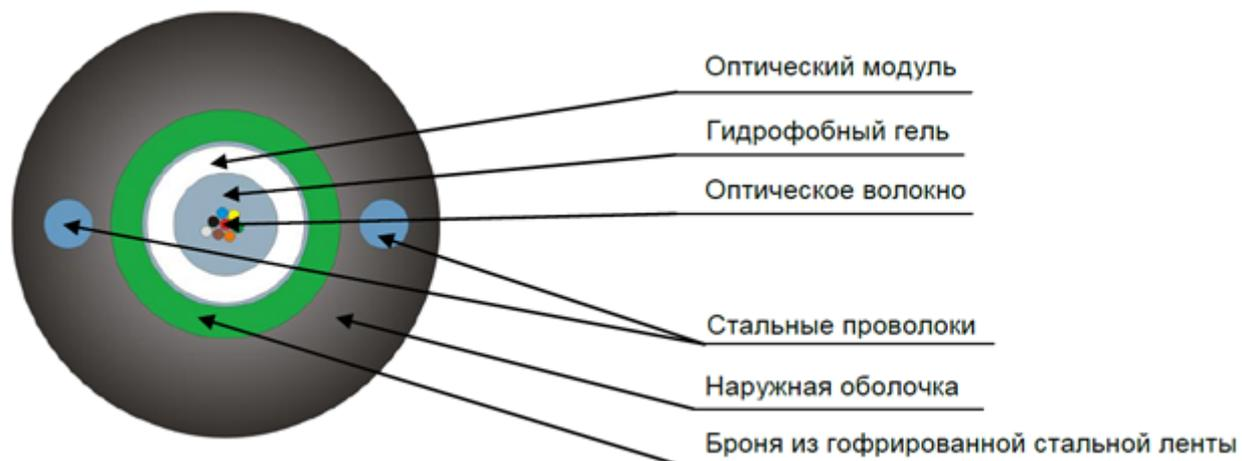
Кабель подразделяется на 2 типа ( №1- LAN-OFC-GYXTWххуу1; № 2 - LAN-OFC-GYXTWххуу2 )
