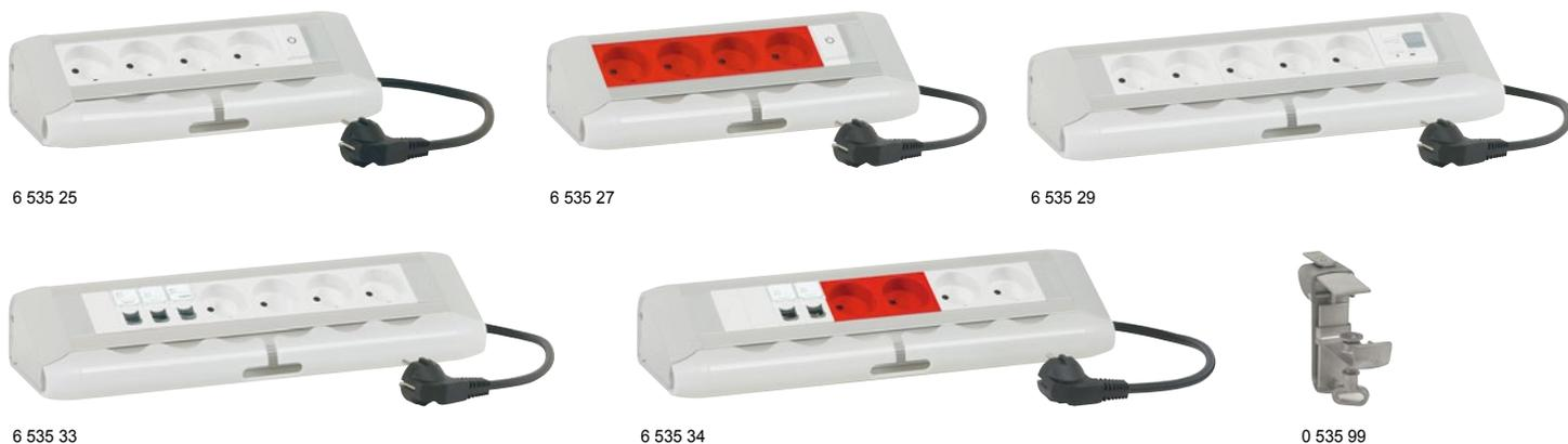
Алюминиевые блоки с кабельными органайзерами (реверсивными) для упорядочивания части шнуров подключённого оборудования. Розетки 2К+3 с отверстиями, расположенными под углом 45° для удобства подсоединения угловых вилок – 16 А – 250 В~, с защитными шторками
