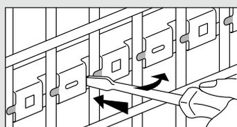
Опоры обеспечивают быструю установку направляющих для кабелей
