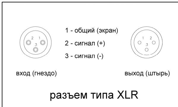
Рис.3. Функциональное назначение выводов разъемов XLR.
