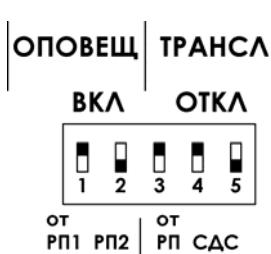
Режим ОПОВЕЩЕНИЕ предусматривает включение реле, осуществляющее обход регулятора громкости в АС при трёхпроводной системе разводки, а также подключение выхода усилителя на момент работы РП1 или РП2.
