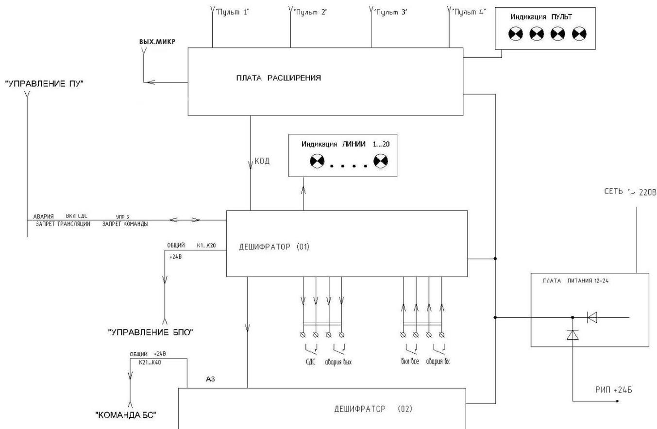
Блок БСВ осуществляет связь между пультами МЕТА 8581 и системой МЕТА. В зависимости от модификации блока к нему может подключаться до 8 пультов.
