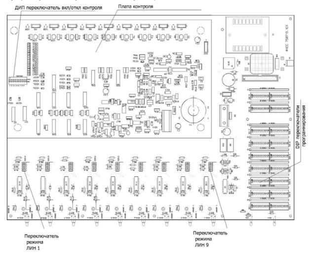
Узел программирования предназначен для установки режимов включения линий оповещения при работе с пультами META 8581 и META 8582.
