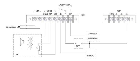
Подключение световых указателей и замков производится к клеммам ДИСТ.УПР. Ток по этим клеммам не должен превышать 10А. Сечение проводов должно быть достаточным для их надежной работы.
