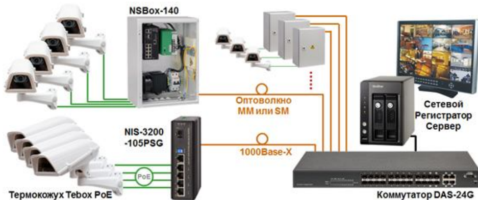
Рис. 1. Электрическая схема Узла доступа NSBox-140-R
