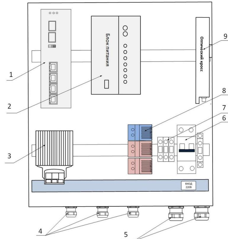
Рис. 2. Базовая комплектация Узла доступа NSBox-243\*
