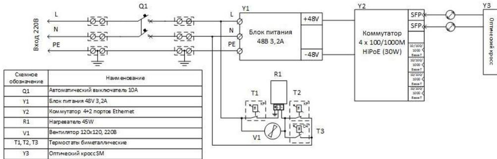
Рис. 1. Электрическая схема Узла доступа NSBox-243
