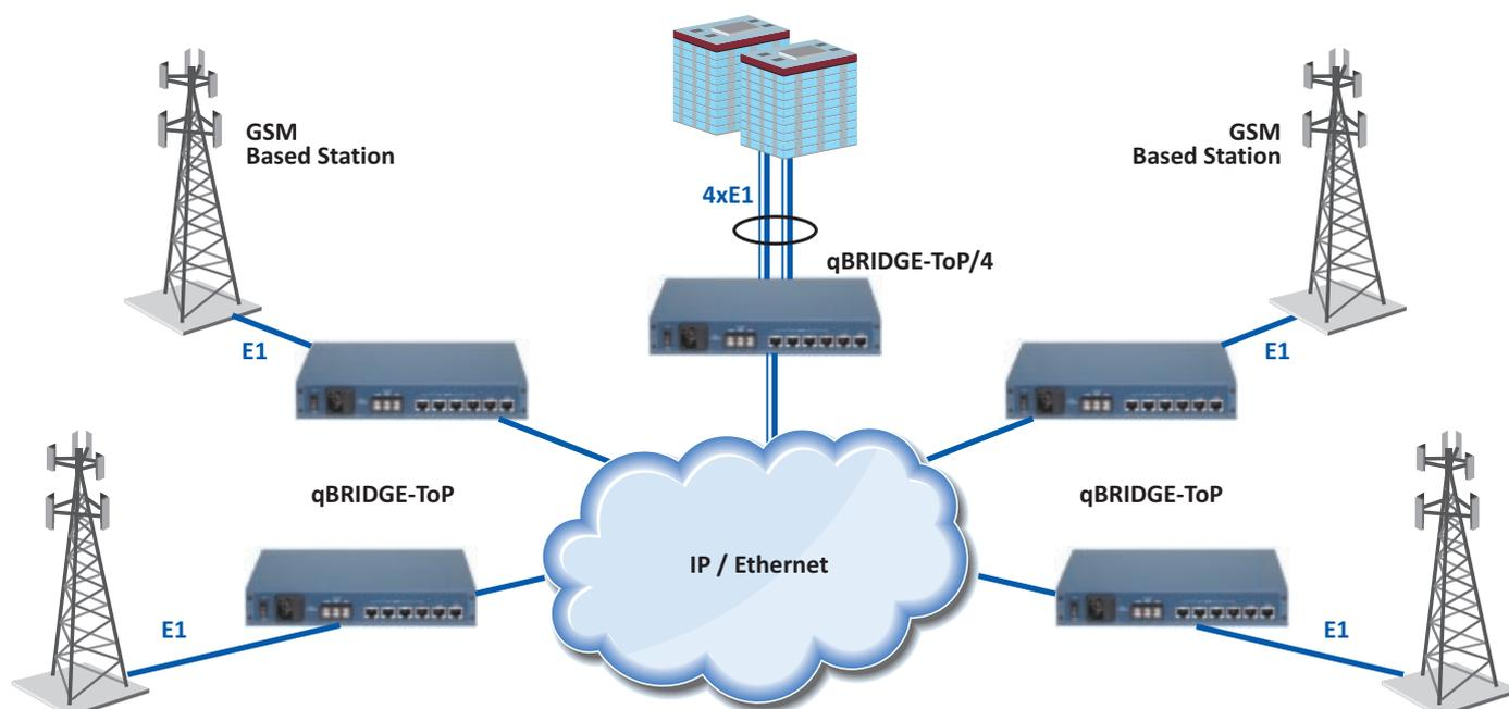
Устройства могут использоваться также для подключения базовых станций сотовой связи к контроллеру и создания удаленных абонентских узлов доступа к центральному узлу сети оператора с предоставлением интегрированных услуг по передаче голоса и данных.
