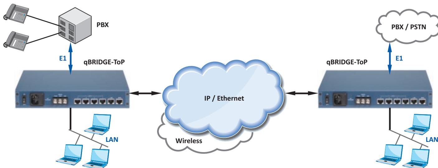
Уникальные технические параметры устройства, в том числе оригинальный алгоритм восстановления синхронизации, обеспечивают необходимое качество услуг, высокую производительность и надежность. Важным достоинством устройства является устойчивая работа через линии радио-Ethernet и беспроводные IP-сети (Wi-Fi Wireless LAN).
