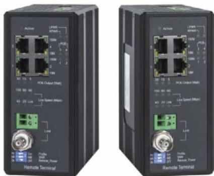
VDSL2 конвертеры **qBRIDGE-307b-PoE** и **qBRIDGE-307b-PoL** предназначены для организации систем IP-видеонаблюдения и передачи цифровой видеоинформации с удаленных на расстояния более 100 м IP-видеокамер по коаксиальному кабелю или витой паре. Кроме передачи данных, эта пара конвертеров позволяет подавать питание по линии связи на видеокамеры.
