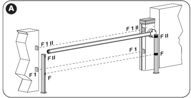
(\*) Можно установить передатчик или приёмник в специально отведённом месте в корпусе шлагбаума (рис. 43).
