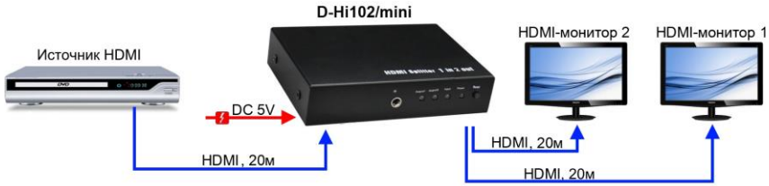
Рис. 3 Схема подключения разветвителя D-Hi102/mini
