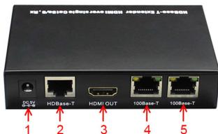
Рис. 4 Элементы приёмника HDBaseT.
