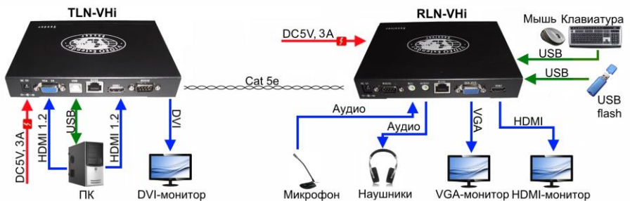
Рис.3 Схема подключения передатчика TLN-VHi и приемника RLN-VHi
