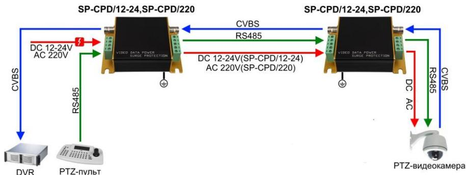
Рис. 3 Подключение SP-CPD/12-24
