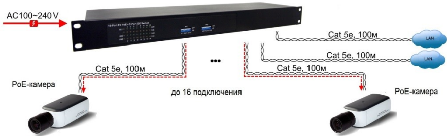
Рис. 8 Схема подключения SW-21620/B
