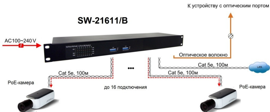
Рис. 7 Схема подключения SW-21611/B
