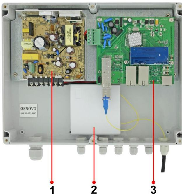
Рис.2 Коммутатор SW-40501/WC, внутренние элементы
