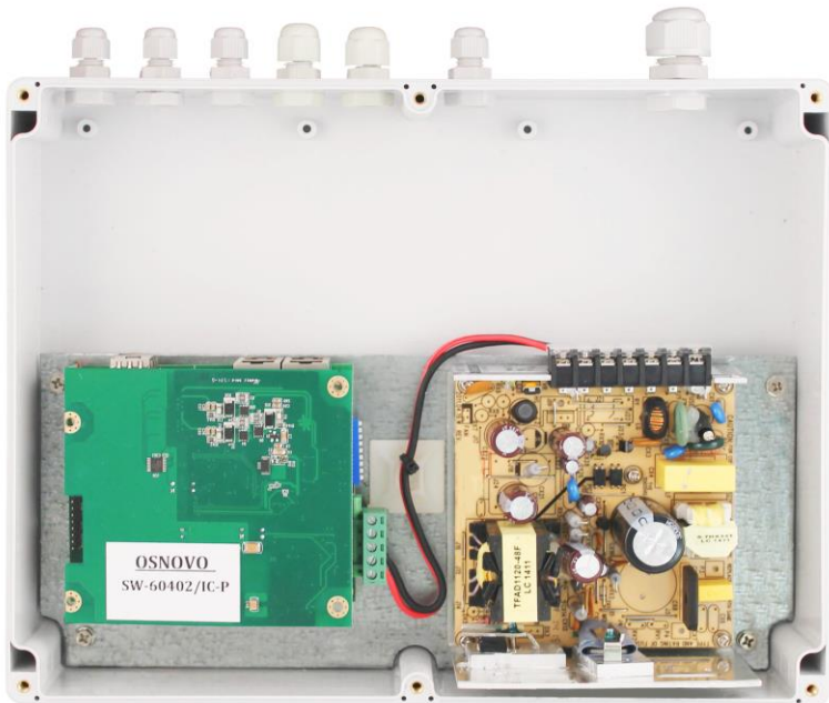
Рис.4.2 Коммутатор SW-60402WC, вид со снятой крышкой бокса
