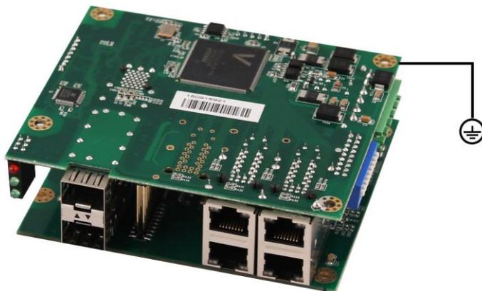
Рис.7 Заземление коммутатора SW-60402/IC-P
