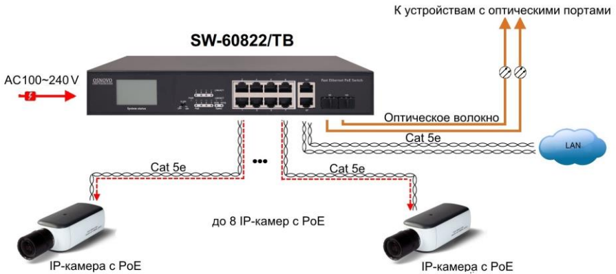
Рис.6 Типовая схема подключения коммутатора SW-60822/TB
