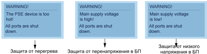
Рис. 7 Дополнительная информация на TFT-дисплее коммутаторов SW-61622/TB, SW-61622/TB(330W), SW-62422/TB
