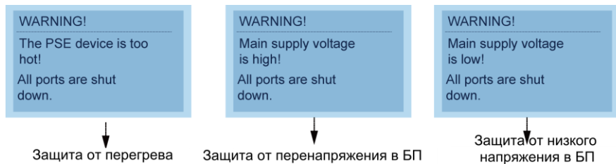
Рис. 7 Дополнительная информация на TFT-дисплее коммутаторов SW-8162/TB и SW-8242/TB
