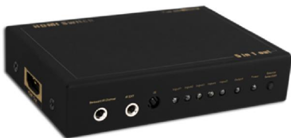
Рис. 1 Коммутатор SW-Hi501, вид спереди.
