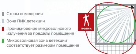
В извещателе CDX-DAM предусмотрена функция настройки микроволновой зоны, которая позволяет установить ее дальность (9, 12 или 15 м) в зависимости от размера помещения.
